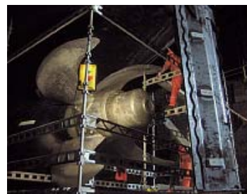
Fejlen i skruehovedet udbedres, inden den videre rejse mod Færøerne. Foto: Minik Rosing
