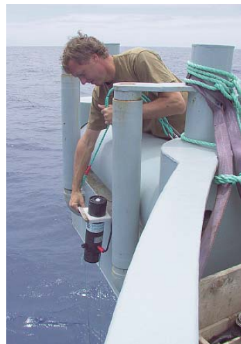
Projektleder Stiig Markager måler ultraviolet lys i vandsøjlen ud for Broome i Nordaustralien. Bemærk, at vandet er meget blåt, hvilket viser, at indholdet af opløst organisk stof er meget lavt. Foto: Winnie Martinsen
