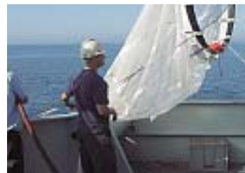
Figur 5: Her udsættes ringnettet, der bruges til fangst af fiskelarver. Foto: Peter Munk
